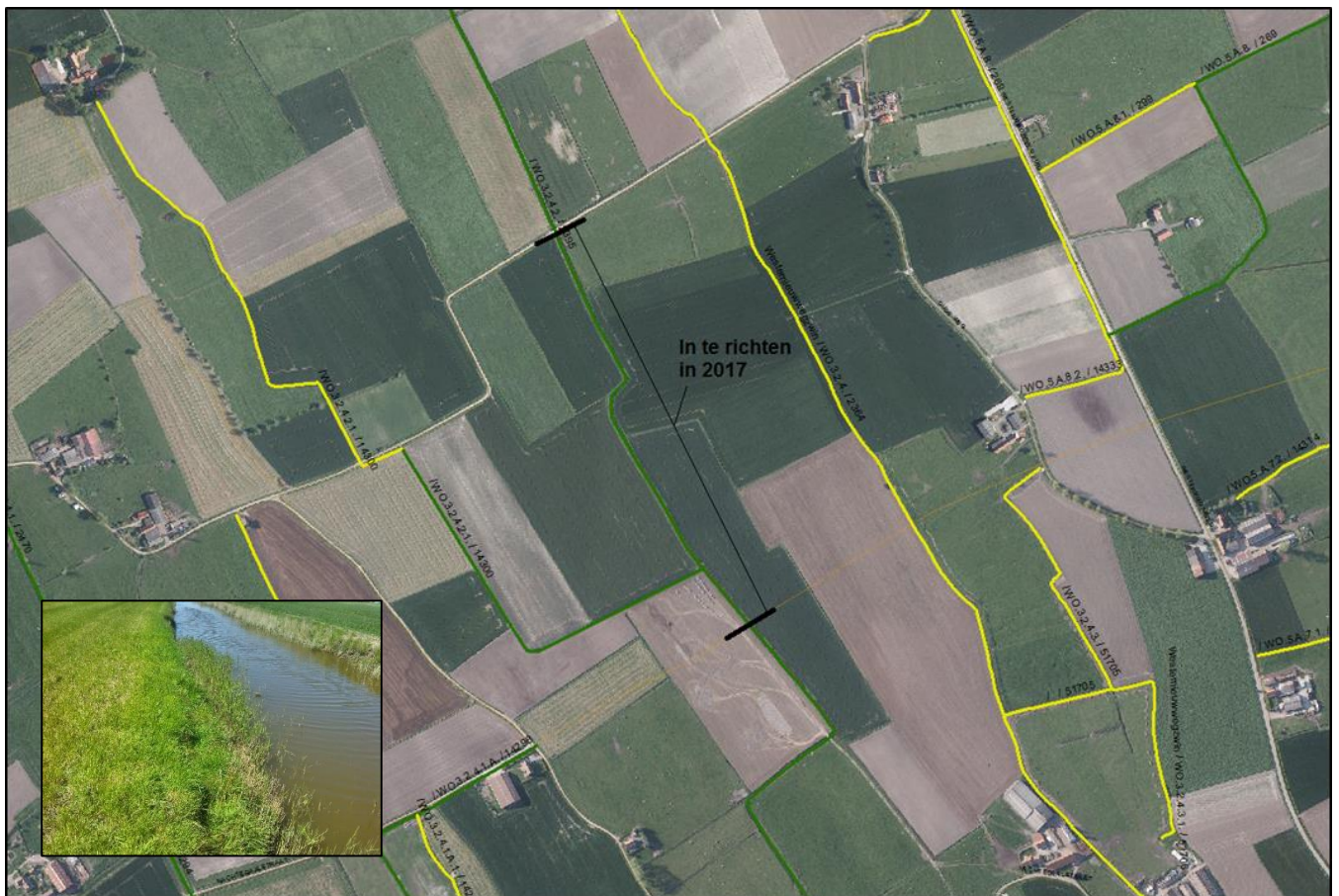
Figuur: Voorstel in te richten deel 2017 waterloop nr. 0.3.2.4.2., inzet: de oevers kalven steeds verder af.
