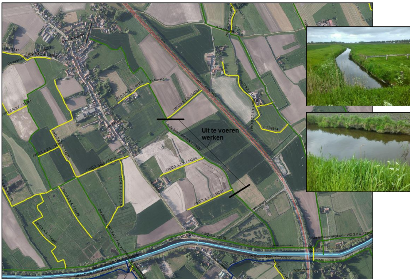
Figuur: Voorstel in te richten deel 2017 “Ader Riethoek Stahille”, bovenste inzet: reeds ingericht deel stroomopwaarts de Cathilleweg, onderste inzet: hevige afkalving van de oevers.
