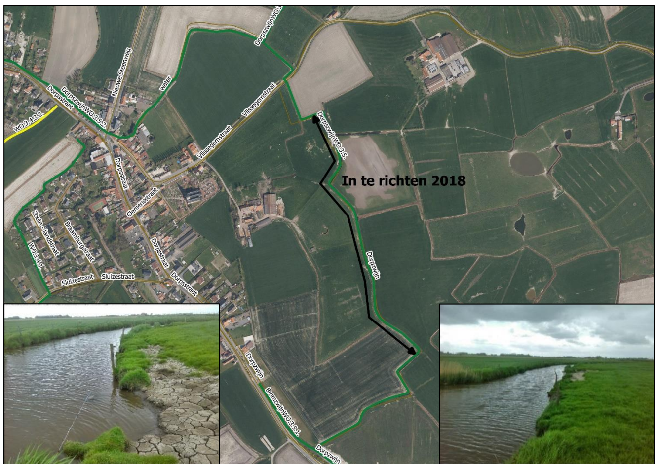
Figuur 24: Waterloop nr. O.3.5. voorstel in te richten deel 2018, inzet (2x): de oevers vertonen na jaren afkalving grote insijdingen ter hoogte van de oeverzone langs de percelen.
