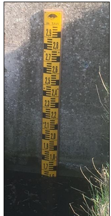
Figuur 38: Plaatsen of vervangen van nieuwe peillatten.
