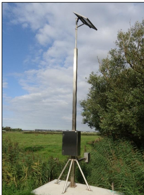
Figuur 42: Nieuw meetpunt, gemonteerd op een sokkel (P3).
