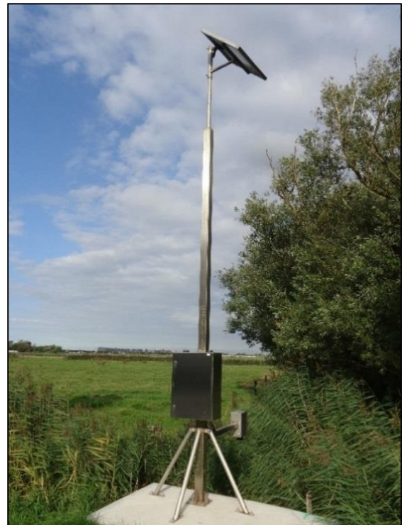
Figuur 34: Nieuw meetpunt, gemonteerd op een sokkel (P3).
